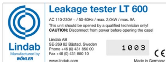
Rysunek 5: Tabliczka znamionowa i numer seryjny urządzenia
