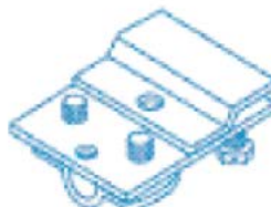
maszt pręta odgromowego mocowany trzema śrubami kod nr: F1
